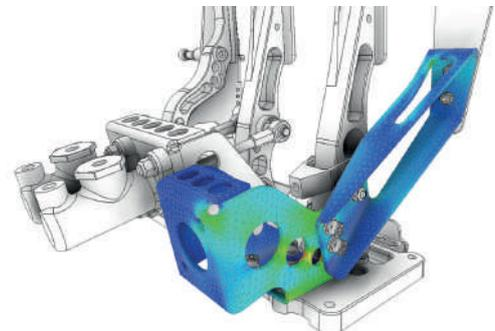
Verifique las condiciones de carga máxima con pandeo no lineal
