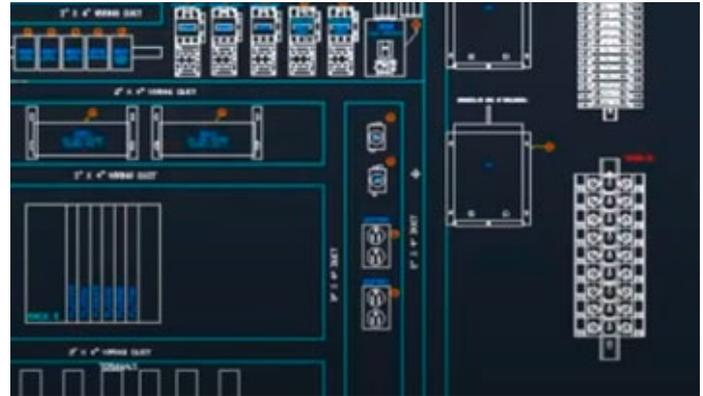
AutoCAD Electrical le permite generar dibujos de PLC I/O automáticamente desde documentos de hojas de cálculo como Microsoft Excel.
