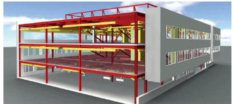
Con Model file y Data aggregation es posible combinar datos de proyectos en un solo modelo integrado
